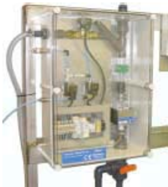
슬러지 모니터링 분석기(SMA)의 투명한 플라스틱 덮개는 쉽게 진행공정을 모니터링할 수 있게 한다.
